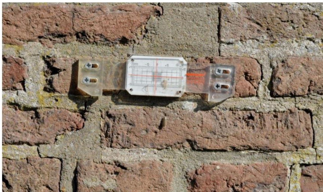
Waterpassing voor monitoring ongelijkmatige zetting – rotatie
